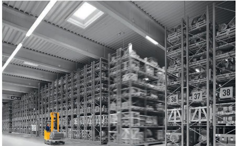
**Bild 5:** Um ständig 60 000 Antriebe vorrätig zu haben, benötigt man ein kluges Konzept – die Paletten werden mit EDV-Unterstützung ein- und ausgelagert
