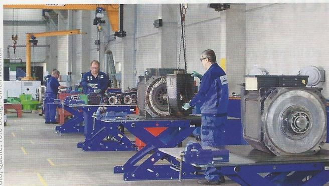
Reparatur- und Wartungsarbeiten an Elektro-Antrieben bilden noch heute den Schwerpunkt bei Clemens Lammers.
