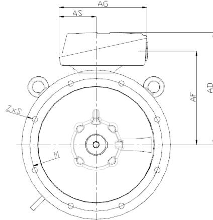
Fuß- Flanschbauformen feet / flange type of construction
