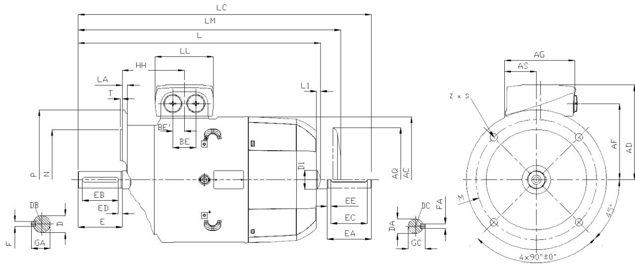
Fuß- Flanschbauformen feet / flange type of construction
