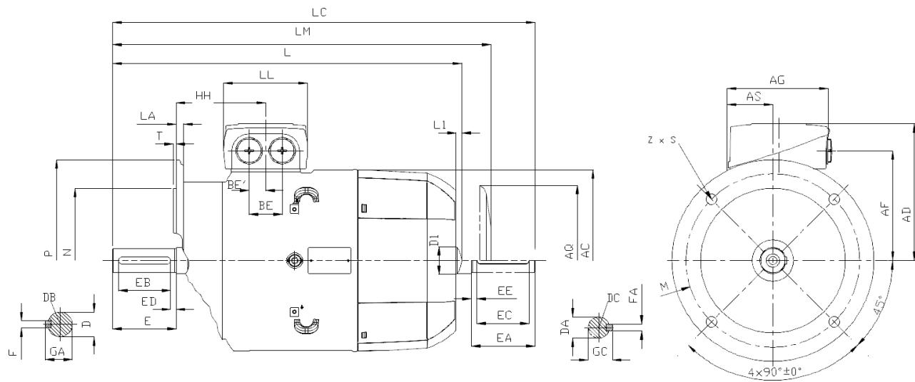
Fuß- Flanschbauformen feet / flange type of construction
